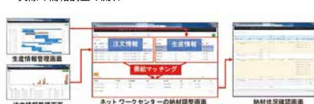
■産地還元型木材SCMシステムにおけるPC画面上での実際の需給調整の流れ
