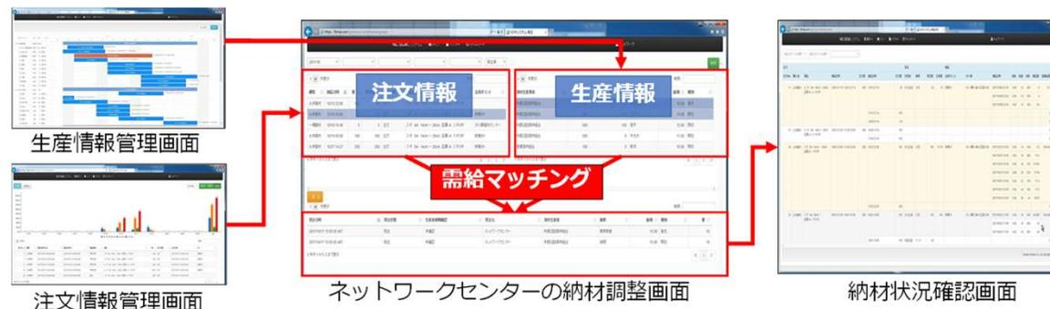
産地還元型木材SCMシステムにおけるPC画面上での実際の需給調整の流れ
